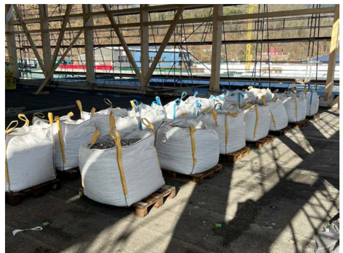
Als Lasttest der Bestandsdecke dienten mit Sand befüllte Big Bags.
