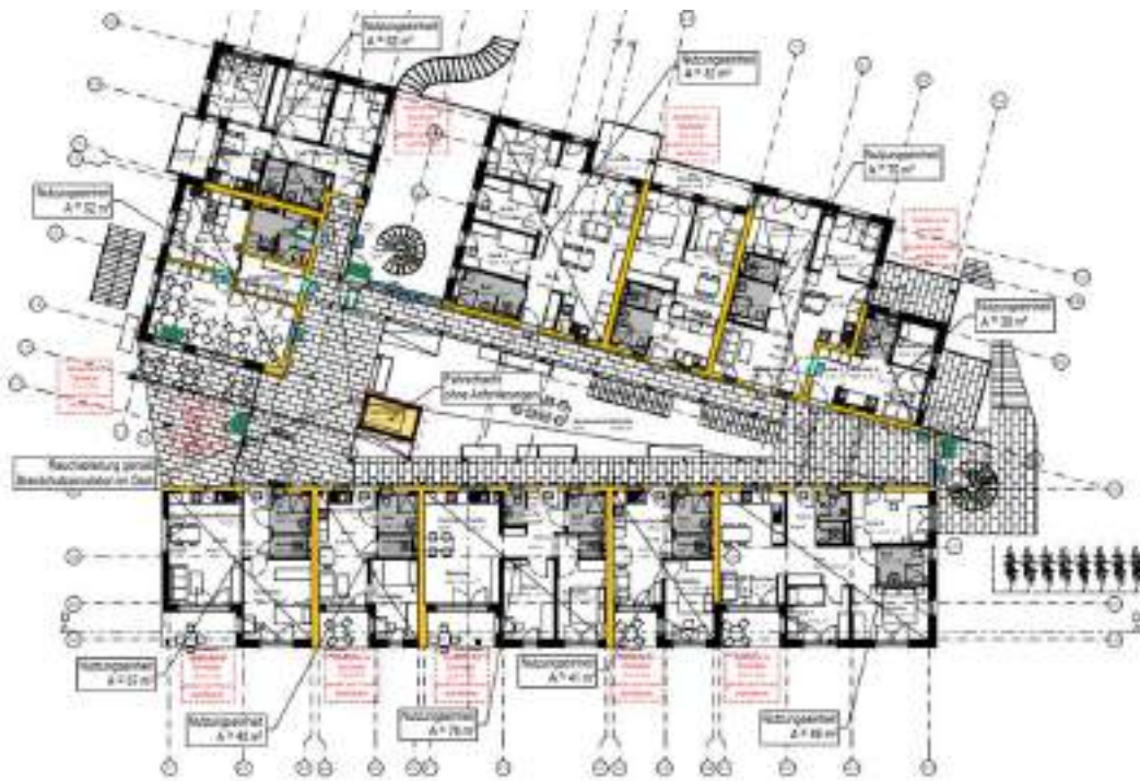
Abbildung 2 Brandschutzplan Erdgeschoss Quelle: Sinfiro Brandschutzin- genieure, Balingen
