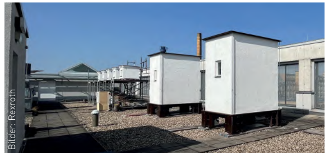
Outdoor-Teststände. Im Vordergrund zwei der neueren, größeren Messkästen (Projektphase 2), im Hintergrund die sogenannten Messwürfel (Projektphase 1).
