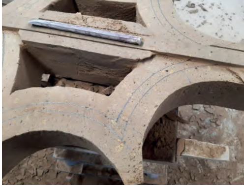
Der Herzstein eines Maßwerkfensters entsteht: von der ersten Kontur bis zum fertigen Stein.
